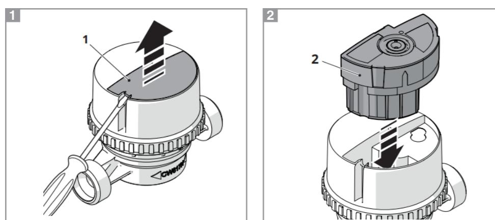
За правильного затягування світлодіод (4) постійно світиться протягом 10 с, а потім блимає одну хвилину, перш ніж згаснути. Модуль Domo R активований (радіопередавач увімкнений / функції активні). Вимірювання розпочнеться через кілька обертів літрового покажчика (процедура самокалібрування).
