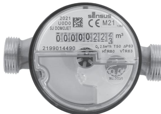
El dispositivo detecta las revoluciones del indicador de litros. A continuación se envía la lectura a un sistema M-Bus estándar. Durante el funcionamiento, el módulo recibe alimentación eléctrica de la red M-Bus. Una batería integrada suministra alimentación eléctrica cuando el contador está desconectado temporalmente de la red M-Bus.
