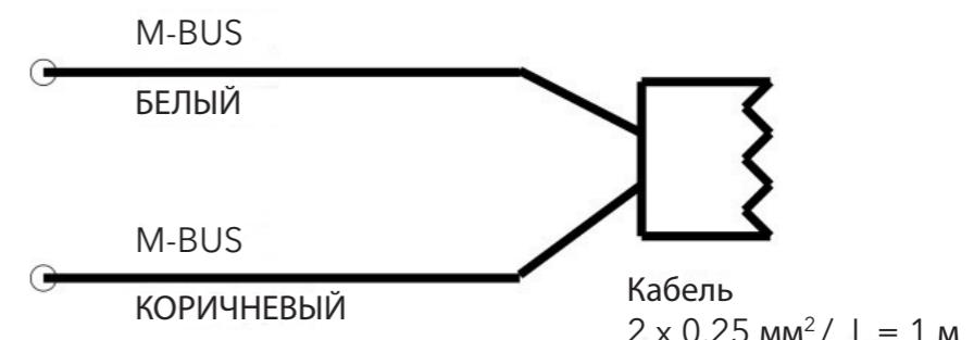
Удлинение кабеля в соотв. со стандартом M-Bus
