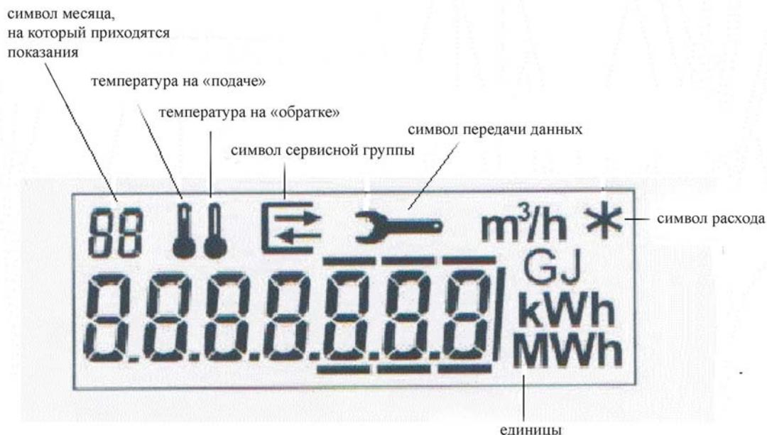
Рисунок 3. Схема дисплея вычислителя
