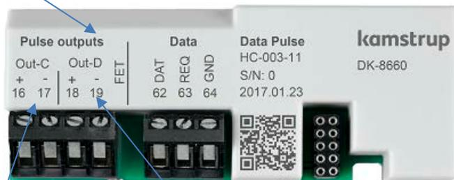
Также обозначены клеммы выхода Out- C и клеммы выхода Out-D.
