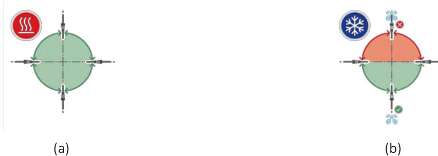
Рис. 6. Допускаемая ориентация датчика температуры в системах (a) теплоснабжения и (b) охлаждения.
