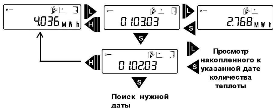
Рисунок 7 - Просмотр ежемесячного архива теплосчетчика
