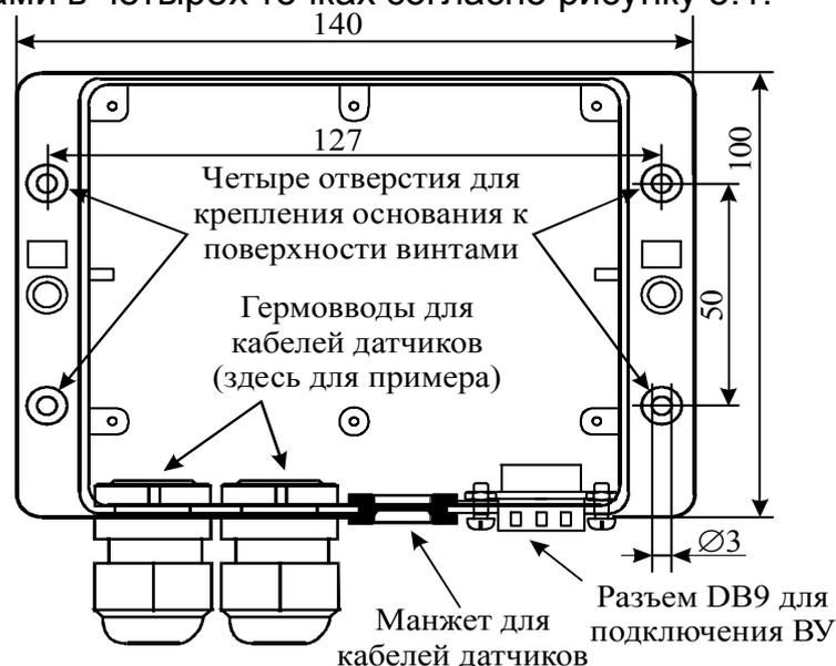
Рисунок 5.1 – Схема крепления корпуса МВТ-2М
