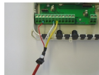
Двухпроводное подключение термометров
