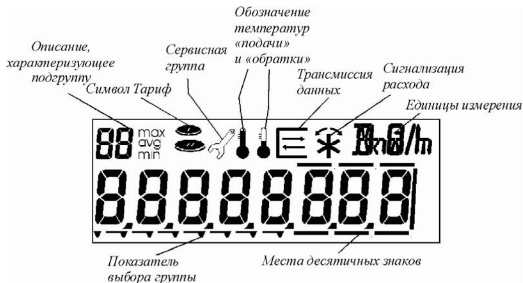
Рисунок 17. Схема дисплея вычислителя теплосчетчика
