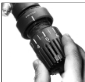
Рис. 11: Маховик надевается таким образом, чтобы цифра „5” находилась напротив указателя настройки. теперь настройка заблокирована в позиции „5” (ок. 50 °С). Затем нажать на маховик так, чтобы он вошел в держатель.
