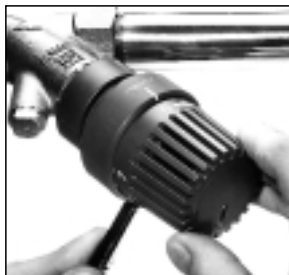
Рис. 12: Снять маховик при помощи инструмента (арт.- № 198 91 00) или штифта, например, кнопкой отвертки. При этом штифт вставить в демонтажное отверстие на нижней стороне термостата. При повороте маховика в положение отключения он может быть легко снят.
