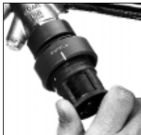
Рис. 13: Снять маховик. Держатель чувствительного элемента ввернуть в штатив, вращая вправо, до упора, затем повернуть влево, затем повернуть направо, так чтобы юстировочная отметка была напротив указателя настройки. (ср. рис. 2.)
