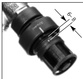
Рис. 14: Может случиться так, что чувствительный элемент полностью выкручен из штатива. Из-за двухзаходной резьбы держателя необходимо правильно насадить его для обратного завинчивания. После окончания юстировки расстояние между штативом и держателем должно составлять ок. 6-8 мм.
