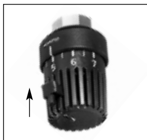
Рис. 16: Значение настройки заблокировано: Вставить инструмент (арт.- № 198 91 00) в маховик так, чтобы одна перемычка оказалась в пазу перед указателем настройки, а другая после него. Инструмент вставить по направлению стрелки и удалить клипсы. Вынуть инструмент.
