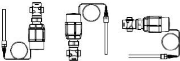
Рис. 4. Монтажное положение регулятора при температуре регулируемой среды до 150 °С – VG, VGF и до 160°С - VGS.
