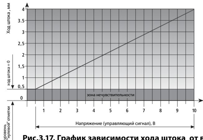
Рис.3.17. График зависимости хода штока от величины управляющего сигнала
