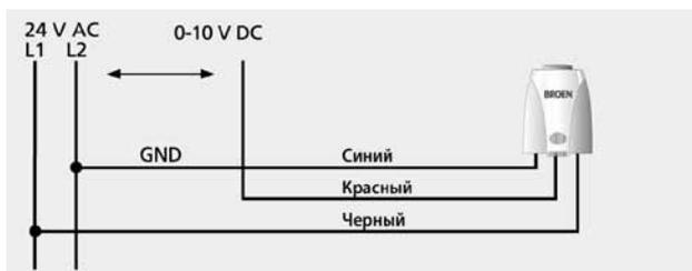
Рис.3.18. Схема подключения привода
