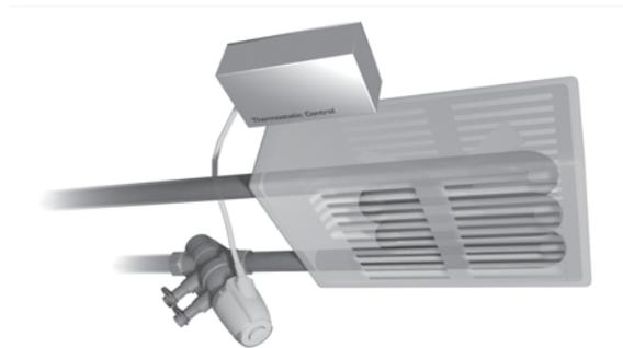
**Рис.3.1. Установка клапана BALLOREX® Dynamic с электроприводом на обвязке фанкойла.**
