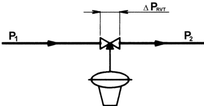
б) с входом редуцированного давления, отбиаемого из трубопровода
