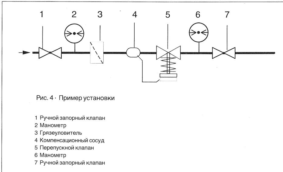
Рис. 4 · Пример установки
