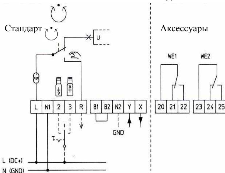
B1 / B2 подключение двухпозиционного сигнала (защита от замерзания)
