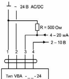
Электропривод VB-90 управляется подачей напряжения на соответствующие клеммы. Встроенные концевые выключатели отключают привод при достижении крайних положений (отсутствие перемещения штока привода).
