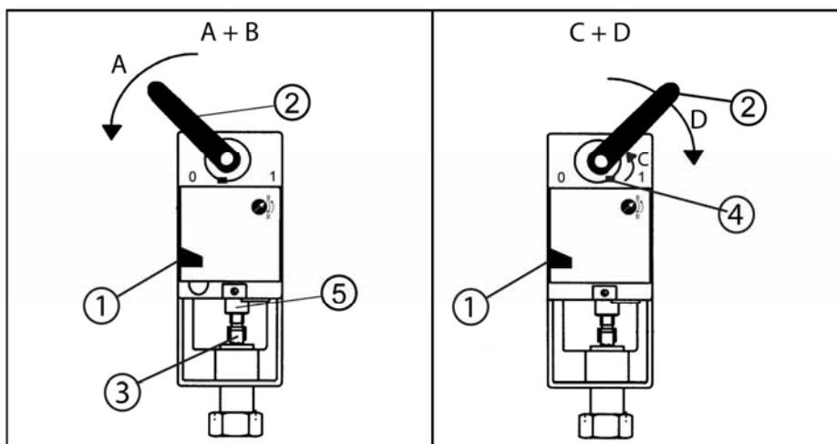
Предварительно на заводе высота хода штока установлена на 10 мм. В зависимости от применяемого клапана должна настраиваться высота хода штока:
