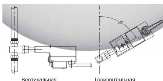
На горизонтальный трубопровод электропривод необходимо ставить под углом в промежутке от  $0^\circ$  до  $60^\circ$  относительно вертикальной оси. Причем чем выше температура регулируемой среды (более  $80^\circ\text{C}$ ) угол должен быть больше (макс.  $60^\circ$ ) во избежание перегрева привода.
