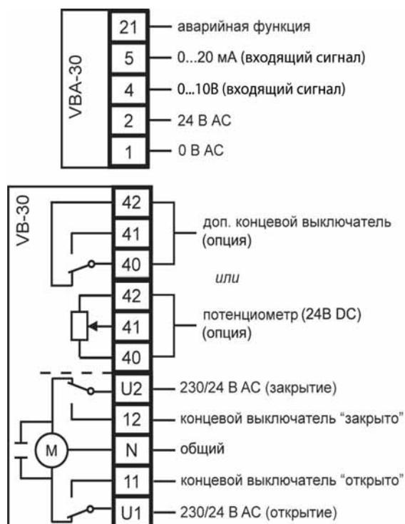
Снимите верхнюю крышку, открутив два винта. Соединение проводится через клеммный разъем согласно электрическим схемам. Кабель управляющего сигнала должен быть экранированным. Сечение проводов питания не менее 0,5 мм и не более 1 мм.
