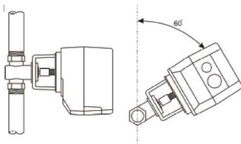
На горизонтальный трубопровод электропривод необходимо ставить под углом в промежутке от 0° до 60° относительно вертикальной оси. Причем чем выше температура регулируемой среды (более 80 °С) угол должен быть больше (макс. 60°) во избежание перегрева привода.
