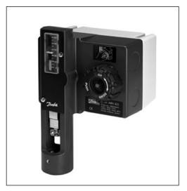
Редукторные электроприводы AMV 323, 423 и 523 предназначены для работы с регулирующими клапанами типа VF2, VF3, VFS2 DN = 15–100 мм, а также VRB3 и VRG3 DN = 15–50 мм, под действием 3-позиционного управляющего сигналаЮ например, от электрических регуляторов серии ECL Comfort.
