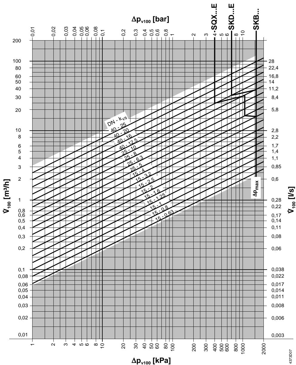
$\Delta p_{max}$  = Максимально допустимый перепад давления через клапан, при котором обеспечивается нормальная работа клапана
