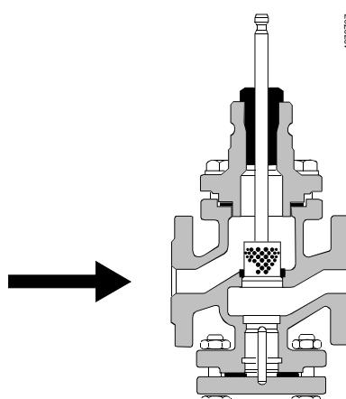
В зависимости от номинального диаметра, используется параболический, перфорированный или профилированный плунжер, который непосредственно присоединен к штоку клапана. Седло привинчено к корпусу клапана с использованием специального уплотнительного материала.
