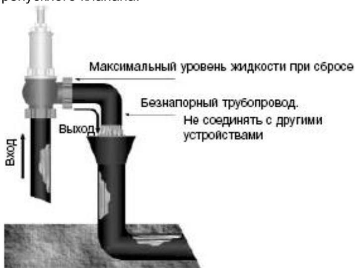
Давление срабатывания возможно изменить, регулируя сжатие установочной пружины в диапазоне от 2 до 12 бар.
