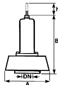
\*при заказе к коду необходимо добавлять букву А, В или С в зависимости от диапазона настройки, к примеру 149B5894В - предохранительный клапан DN 100 с диапазоном настройки 6-12 бар.
