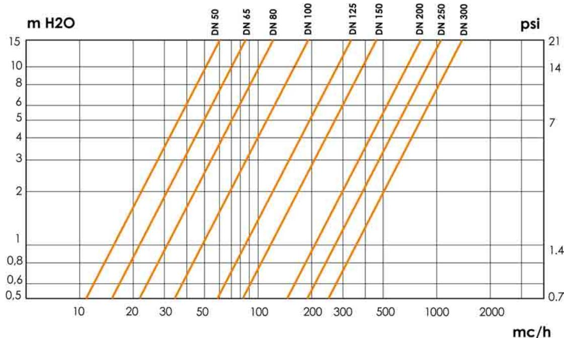
Diagramma perdita di carico. Fluido: acqua
