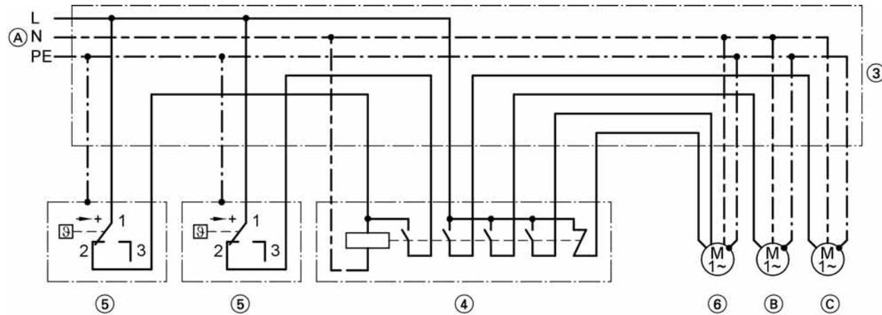
Вентиль с моторным приводом (6) требуется только в случае, если распределительные гребенки подающей магистрали находятся под давлением.
