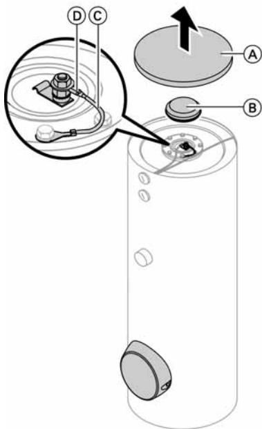
1. Снять крышку (A) и теплоизоляционные маты (B) (у водонагревателя объемом 400 и 500 л 3 теплоизоляционных мата).
