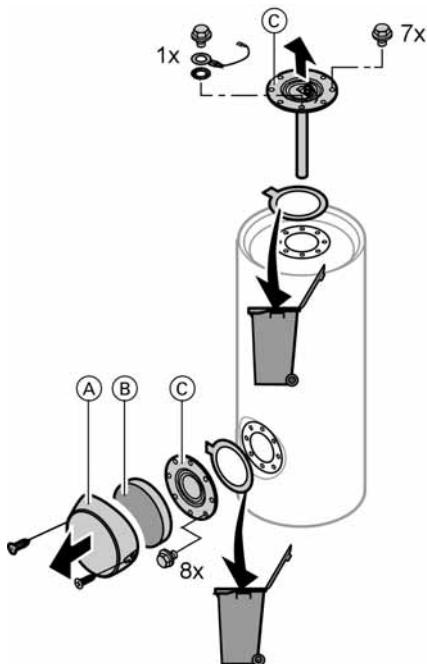
3. Отсоединить емкостный водонагреватель от системы трубопроводов, чтобы в нее не могли попасть чистящие средства и загрязнения.
