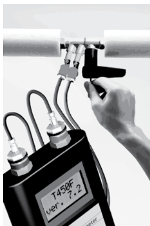
Рис.1.4. Измерение расхода на клапане BALLOREX® Venturi
