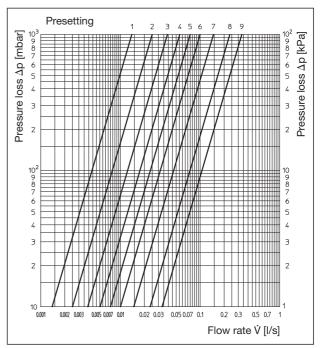
DN 20 and DN 25  $\ensuremath{k_{\text{vs}}}$  values
