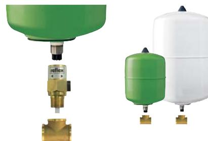
Проточная арматура 'flowjet' берёт на себя функцию колпачкового вентиля и устанавливается между 'refix DD' и тройником. Соблюдены все требования норм - отключение, возможность слива, проток через бак.
