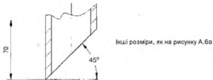
Рисунок А.6а — Бобишка для використання з перпендикулярно встановленим перетворювачем температури (див. рисунок А.8D)
