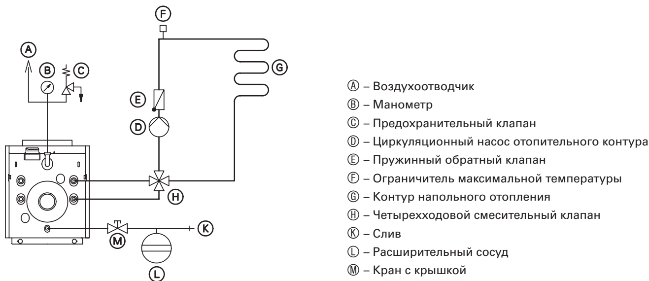
Рис. 4.3. Котел с четырехходовым смесительным клапаном
