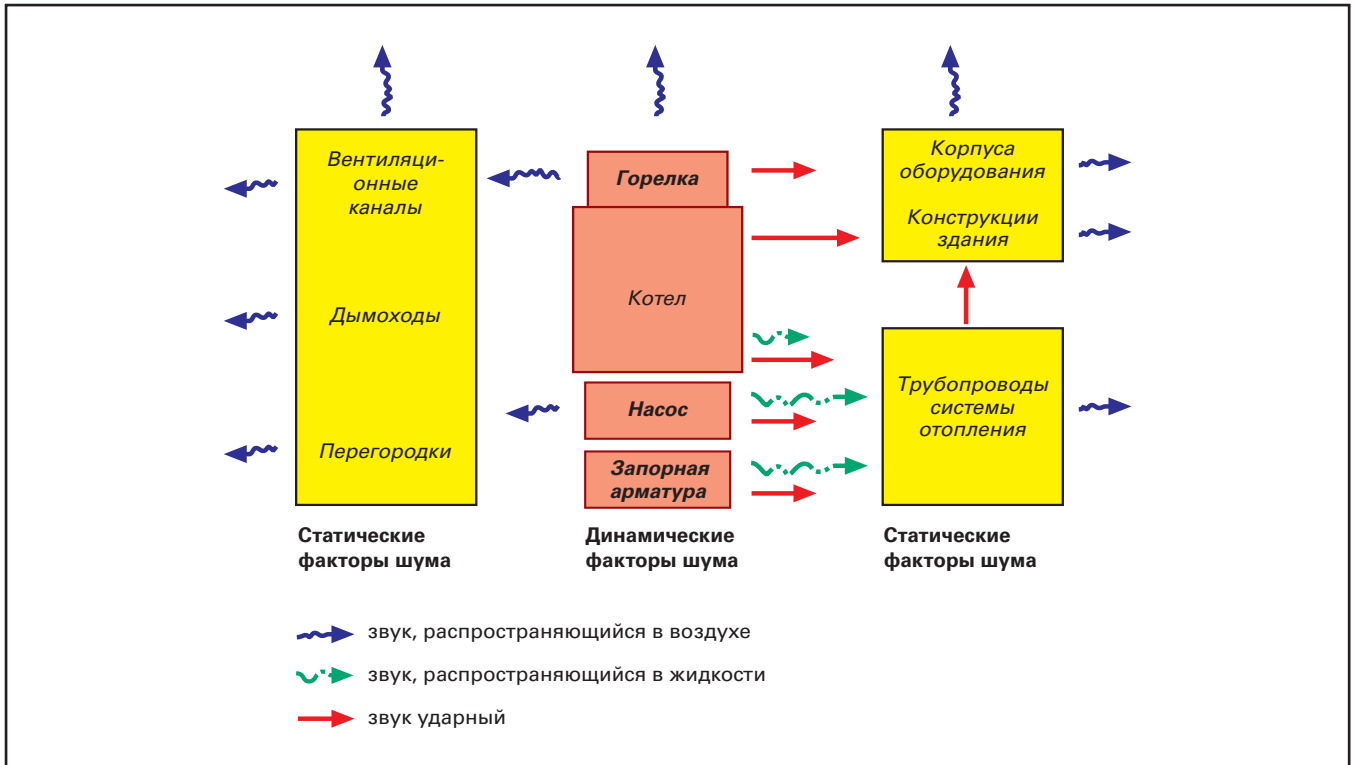
Рис. 14.8. Акустическая модель котельной и системы отопления
