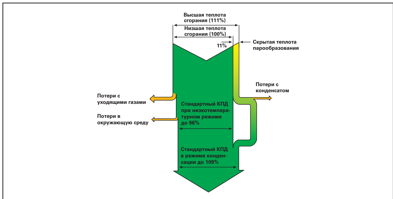
Рис. 8.2. Использование теплоты уходящих газов в конденсационном котле
