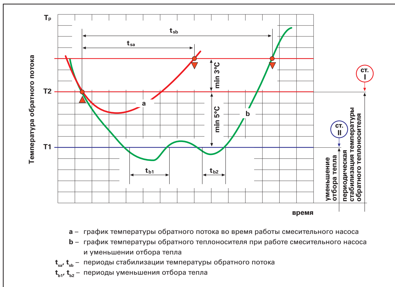
Рис. 3.7. Двухступенчатая система защиты котлов по температуре обратного потока с использованием смесительного насоса – класс C1
