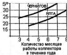
Рис. 3 Зависимость оптимального угла наклона S , град., солнечного коллектора к горизонту от продолжительности его использования
